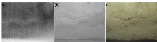
Abb. 7: (a) MIR-, (b) NIR- und (c) VIS-Aufnahme im Rohformat der Wand im Kellergeschoss
